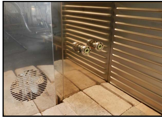
Bild 5.2: Im Wärmeschrank verbaute Storz-D-Kupplungen mit hitzebeständigen Viton-Dichtungen
