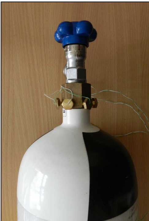
Bild 6.1: Prüfadapter zur Messung der Temperatur im Druckbehälter
