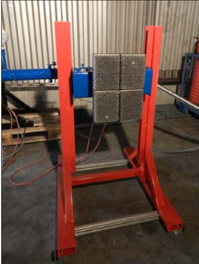
Bild 5.7: Heizfeld auf verfahrbarem Gestell
