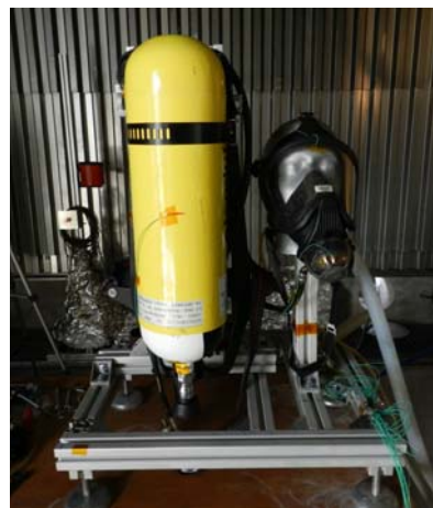
Bild 5.13: Halteplattform für die VS_2 und VS_3
